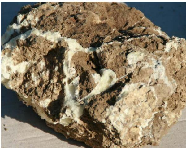
Figura 4 – Un volume di terreno prelevato da sito consolidato con iniezione di resine espandenti. In bianco sono visibili i filamenti di resina poliuretanicata allo stato inerte (Occhi, 2010. Test Site Emilia Romagna).
